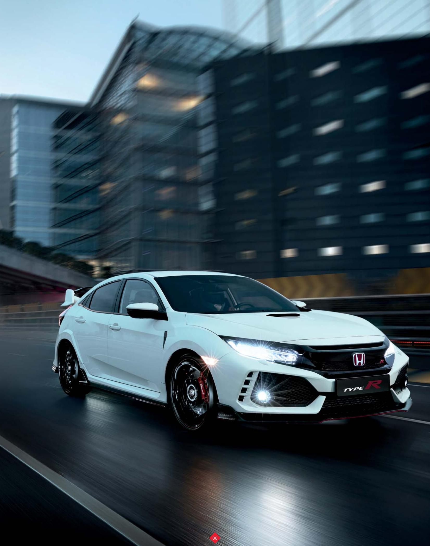
La haute technicité de cette voiture exige des éléments spécifiques empruntés au sport automobile, comme les ouïes de refroidissement des freins, l'aileron arrière, le capot en aluminium doté d'une prise d'air ou encore la triple sortie d'échappement centrale.
